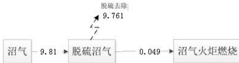
图 4.11-2 本项目沼气硫平衡图 单位：t/a
